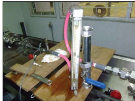
Gambar 6. Standar Cek Pengukur Aliran Jenis Turbin dengan MUT Jenis Rotameter
