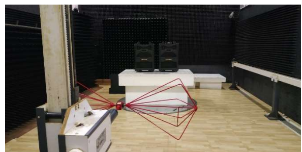
Gambar 2. Set Up pengambilan data 30 – 300 MHz menggunakan antenna Biconnical
