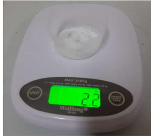
**Gambar 2.** Nilai referensi salinitas dari NaCl dengan metode penimbangan
