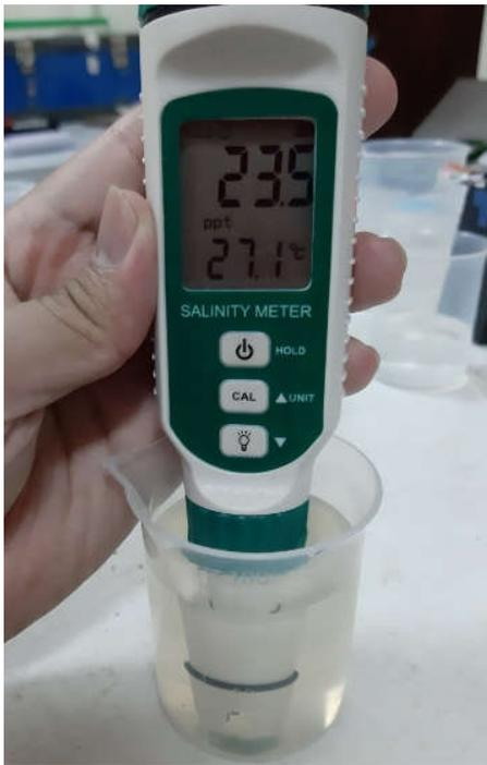
**Gambar 3.** Pengukuran salinitas dengan metode daya hantar listrik
